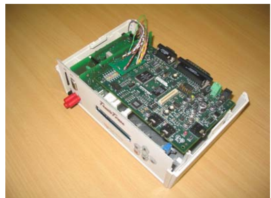
Foto 1. TensioTrace – seade vererõhu pidevaks mitte-invasiivseks jälgimiseks.
